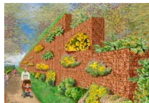
Ce mur antibruit en pierre de pouzzolane présente une bonne capacité d'absorption du bruit et des qualités de filtration reconnues pour la pollution de l'air.
